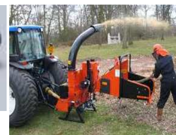
traktoroŝafto de traktoro (tie kuplita kun lignopistilo)
