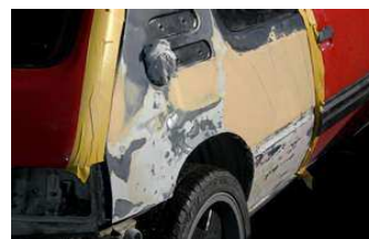
flikado per mastiko antaŭ ol poluri kaj farbi
