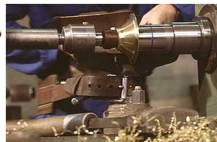
mandreno por retropuŝi latunan ladon sur tornilo
