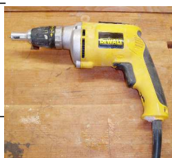
ŝraŭbmaŝino per ŝtopbuteo kaj nutrokonduktilo (por fiksi paneloj)
