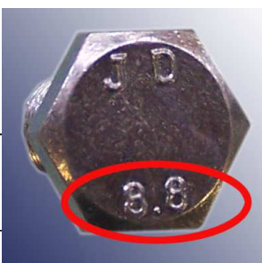
stampo sur ŝraŭbkapo : cedlimo = 8 (80 kg/mm 2 ) elastolimo = 80% (64 kg/mm 2 )
