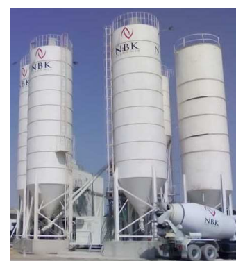
cementosiloj en porbetona centralo
