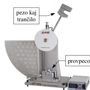
detruiga provo (testo de fleksio per kolizio, maŝino de Mouton-Charpy)
