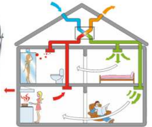
duflua ventolado (elira aero donas siajn kaloriojn por varmigi eniran aeron)
