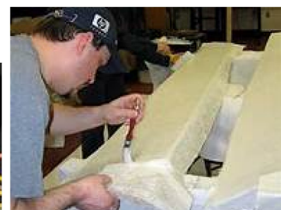
ŝmirado de vitra fibro per rezino
