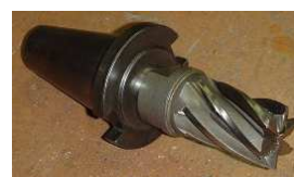
cilindra frezilo por frezmaŝino
