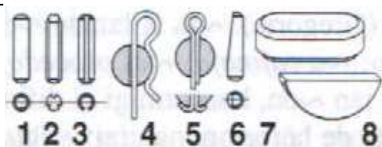
stifto : 1) cilindra ; 2) kanelita ; 3) elasta ; 4) pingla "beta" ; 5) duobla ; 6) kojna "bicikla" ; 7) paralela ; 8) diska.
