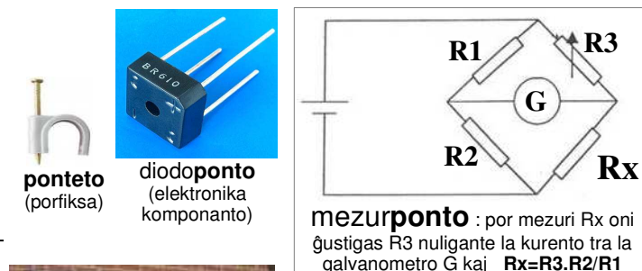
diodoponto : uzi por transformi alterna kurento en rektifita kurento
